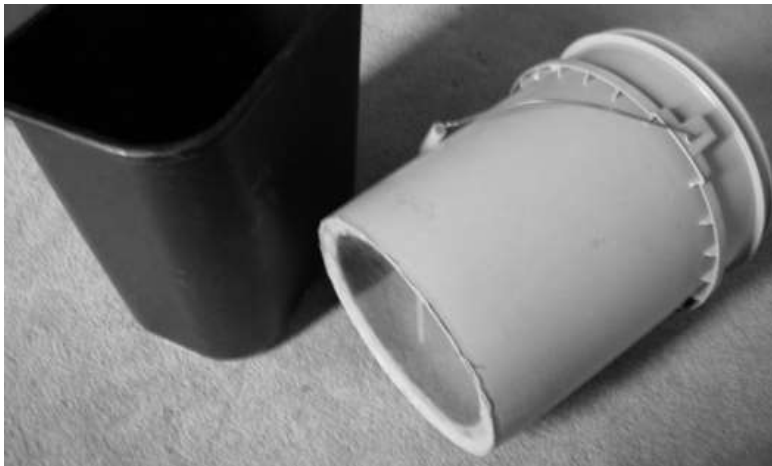
Photo 1 : L'équipement utilisé sur le terrain pour l'échantillonnage : les visionneurs d'eau (waterviewer)
