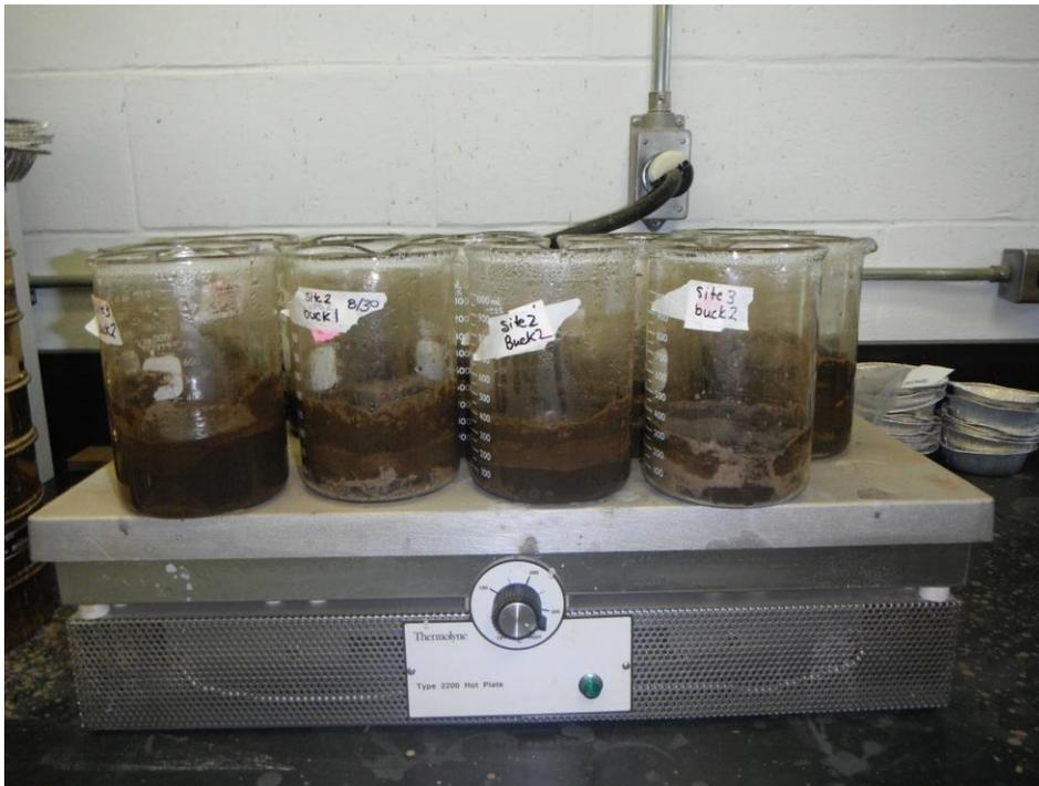
Figure 7. Sédiments sur la plaque chauffante afin d'évaporer l'eau.
