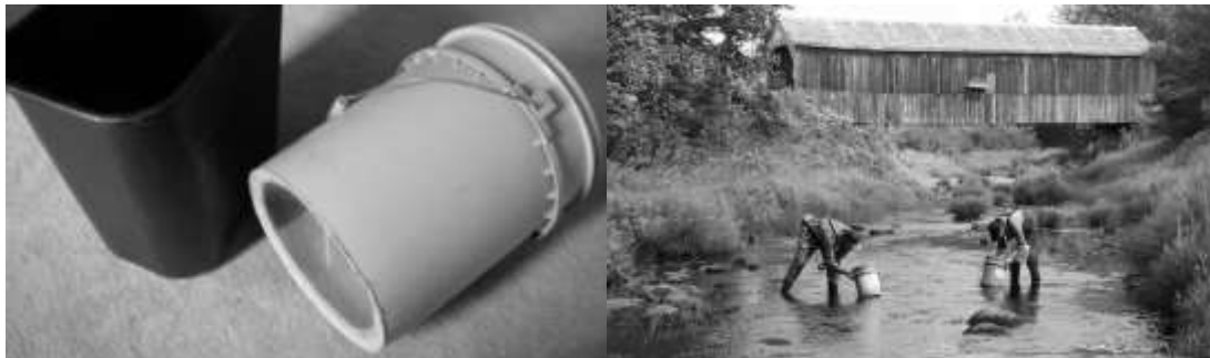
Figure 6 : Photo 1 (gauche) - L'équipement utilisé sur le terrain pour l'échantillonnage : les visionneurs d'eau (waterviewer) Photo 2 (droite) - Les visionneurs d'eau utilisé sur le terrain par des employés
